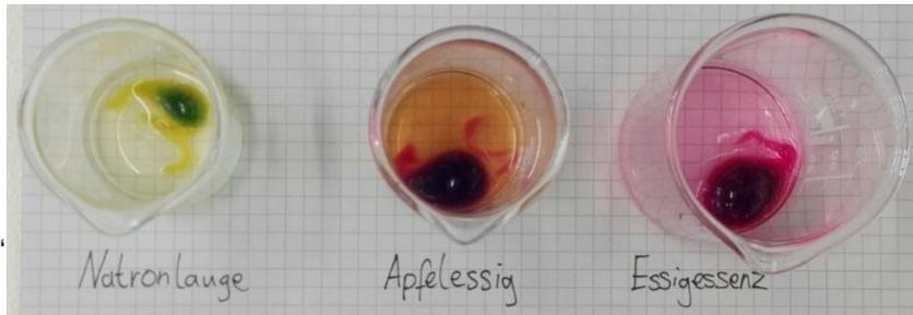
oben: Alginate-Präparate; angefärbt bei verschiedenen pH-Werten
